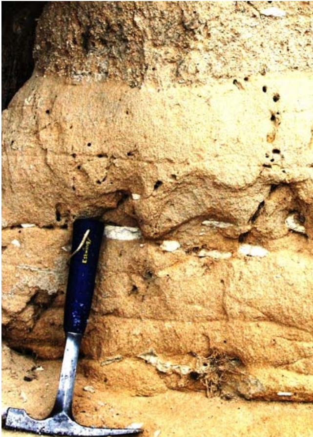
Abb. 6. Hellgraue Tonklasten in Mittelsand, Einheit C.
