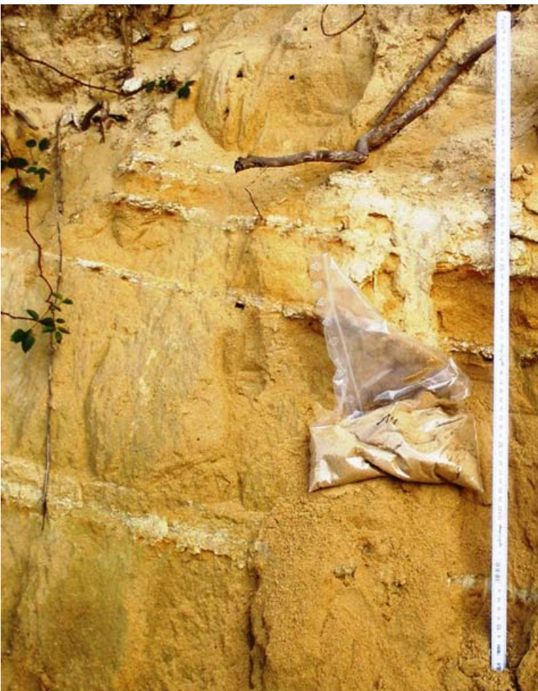
Abb. 5. Typische Wechsellagerung von Sand und dünnen Tonlagen, Einheit B.
