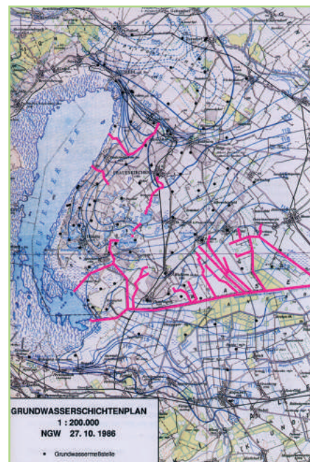
Abb. 2.1: Entwässerungssystem im Seewinkel nach HAAS ET AL (1992), verändert. Die rosa Linien zeigen die Hauptentwässerungskanäle.
