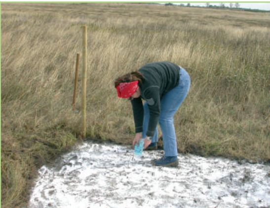
Abb. 2.6: Händische Aufbringung einer Mischung von 4 kg/m 2 einer Mischung von 3:1 Teilen Soda und Glaubersalz auf einer Testfläche im Oktober 2004.
