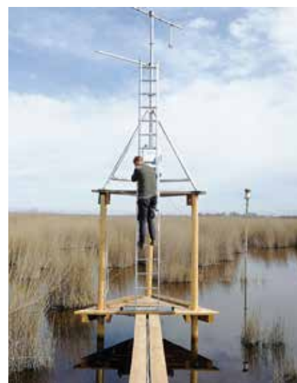
■ Methanmessturm des Kooperationspartners Universität Wien bei der Biologischen Station – eine von sechs Anlagen in Österreich im Rahmen des Infrastrukturprojekts LTER-CWN
